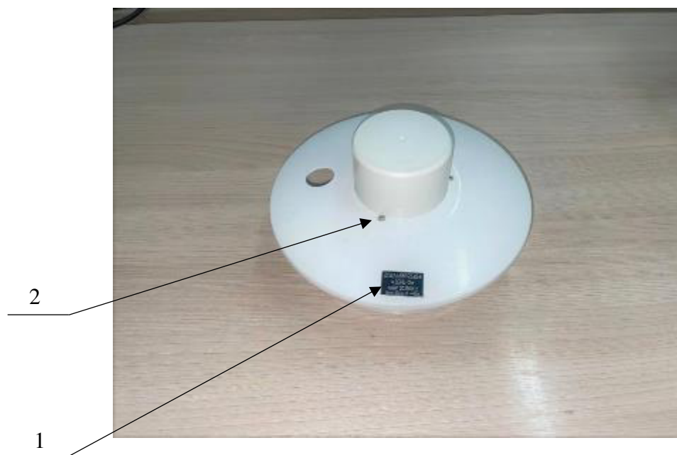
1 – место нанесения зав. номера; 2 – место пломбировки
