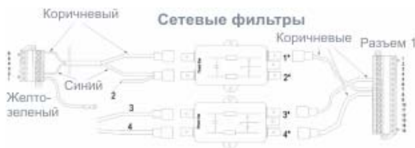
Рисунок 23 Подключение сетевых фильтров к кабельному соединению
