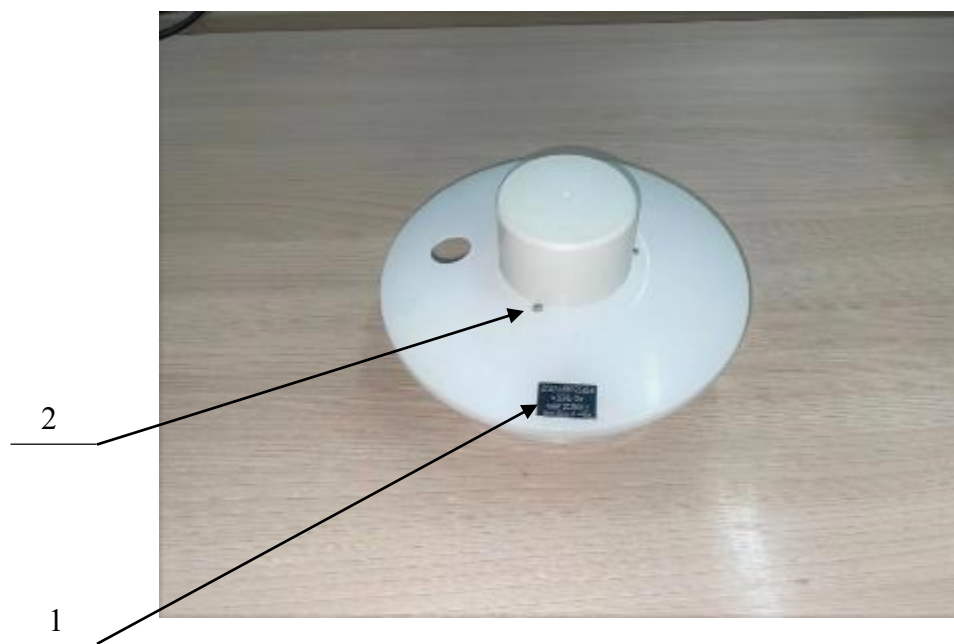
1 – место нанесения зав. номера; 2 – место пломбировки
